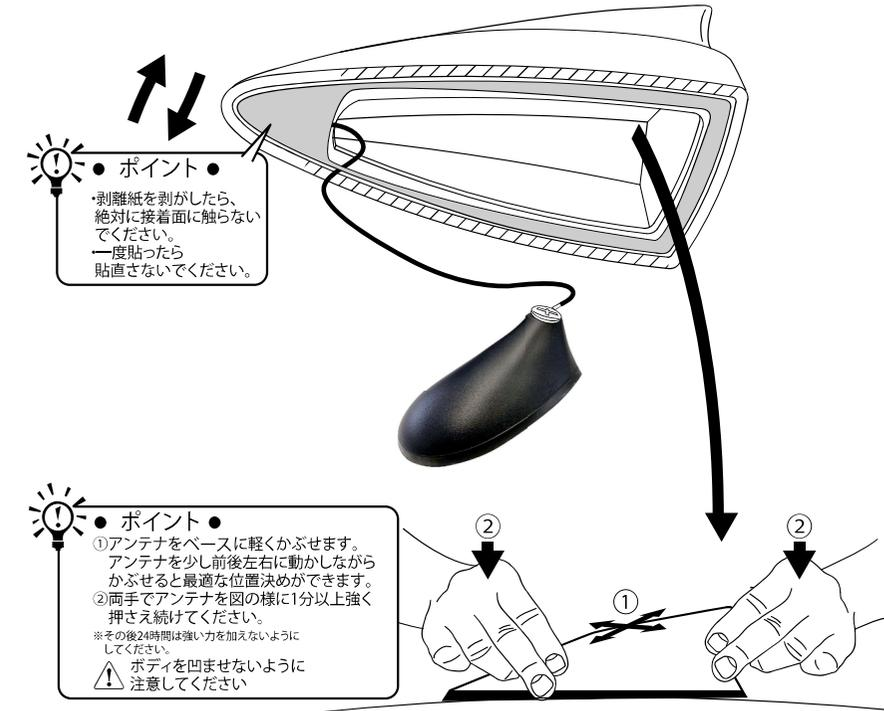
⊘ ※アンテナを載せ替える場合、一度はがしたテープの接着力は著しく低下します。必ず別売りの「載せ替えキットS7-KIT ¥1,100(税別)」をご購入の上、取付を行って下さい。
