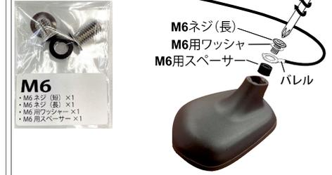
※結線する端子の根元（バレル）は必ず車両後方の向きで固定してください。前方の向きで取付けるとバレルがアンテナ本体と干渉してしまいアンテナの浮きや剥がれの原因になります。
