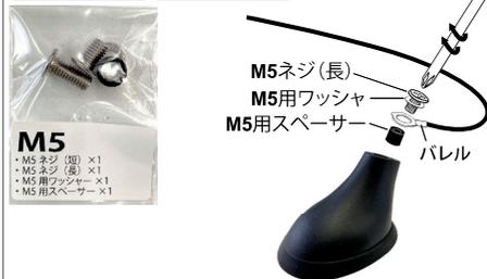
※結線する端子の根元（バレル）は必ず車両後方の向きで固定してください。前方の向きで取付けるとバレルがアンテナ本体と干渉してしまいアンテナの浮きや剥がれの原因になります。
