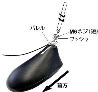
※結線する端子の根元（バレル）は必ず前方の向きで固定して下さい。
