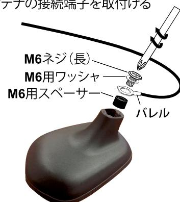
※結線する端子の根元（バレル）は必ず車両後方の向きで固定してください。前方の向きで取付けるとバレルがアンテナ本体と干渉してしまいアンテナの浮きや剥がれの原因になります。
