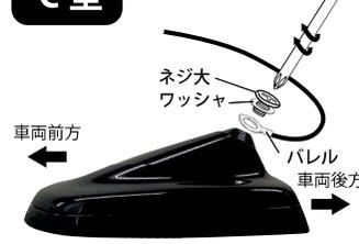
※結線する端子の根元（バレル）は必ず車両後方の向きで固定してください。前方の向きで取付けるとバレルがアンテナ本体と干渉してしまいアンテナの浮きや剥がれの原因になります。
